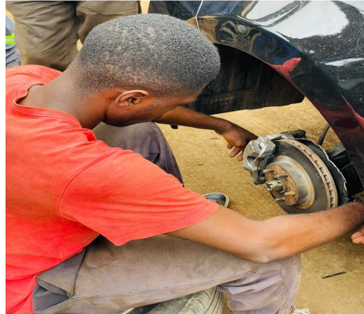
ANNEXE 5 : Travail sur le système de Freinage
